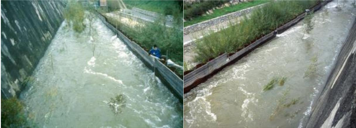
Abbildung 8: Flutungsversuche am Wienfluss an biegesteifen (links) und flexiblen (rechts) Weiden: starre Gehölze stehen auch bei höheren Wasserständen aufrecht, flexible Gehölze legen sich nieder.
